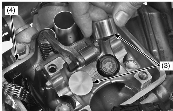
(3) толкатели клапанов (4) головка цилиндра
