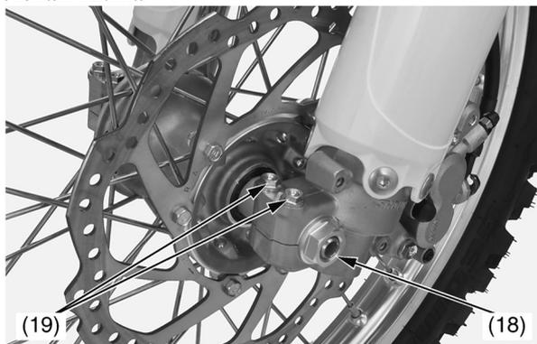
(18) гайка передней оси
