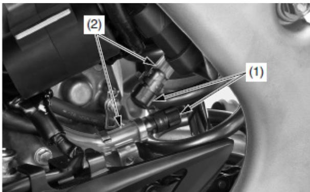
(1) крышки патрубков вентиляционной трубки картера
