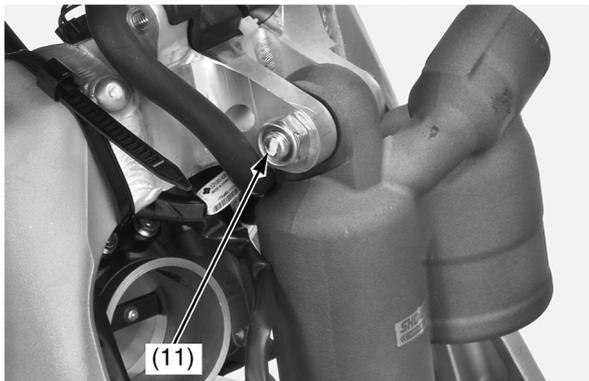
(11) верхняя гайка и болт заднего амортизатора
