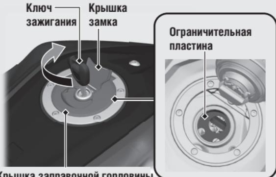
Крышка заправочной горловины топливного бака
