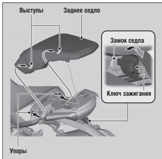
Снятие и установка компонентов обшивки ► Заднее седло
