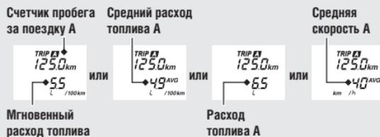
После сброса в каждом из этих режимов на дисплее будет отображаться экран сброса показаний. После этого дисплей вернется в режим, который был выбран до операции сброса.
