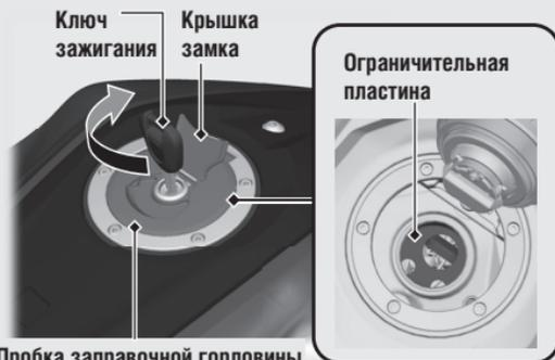
Пробка заправочной горловины топливного бака
