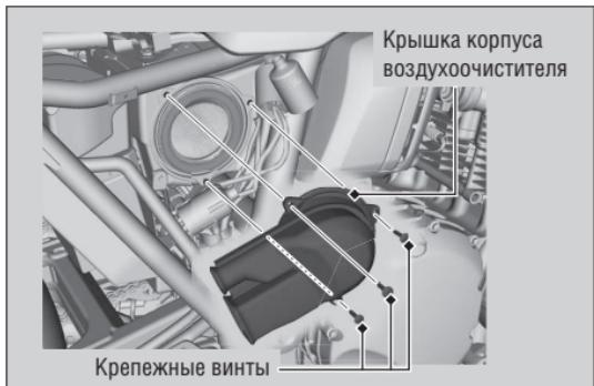
Воздухоочиститель ► Проверка и замена фильтрующего элемента
