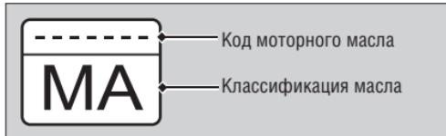
\*2. Стандарт SAE делит моторные масла на классы, в зависимости от их вязкости.
