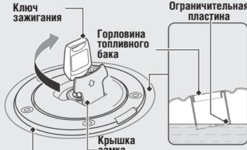
**Крышка заправочной горловины топливного бака**
