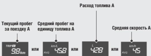
Когда счетчики сброшены, на каждом индикаторе отображается «0.0».
