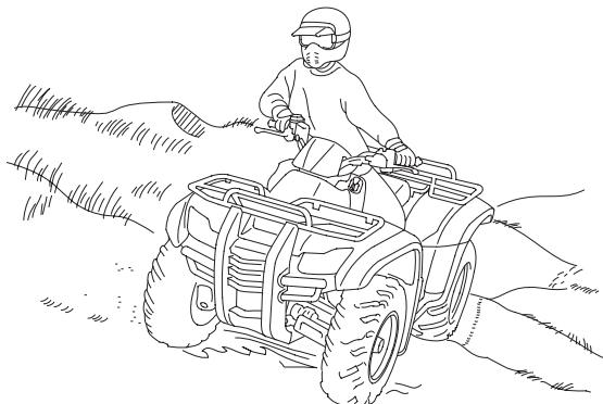
При поперечном движении по склону смещайте вес тела в сторону вершины склона.
