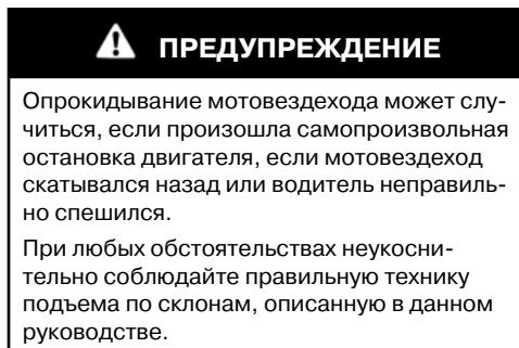
Действия при самопроизвольной остановке двигателя либо скатывании мотовездехода вниз по склону: Если возникла опасность полной остановки мотовездехода:
