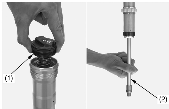
(1) блок клапанов (2) шток поршня
