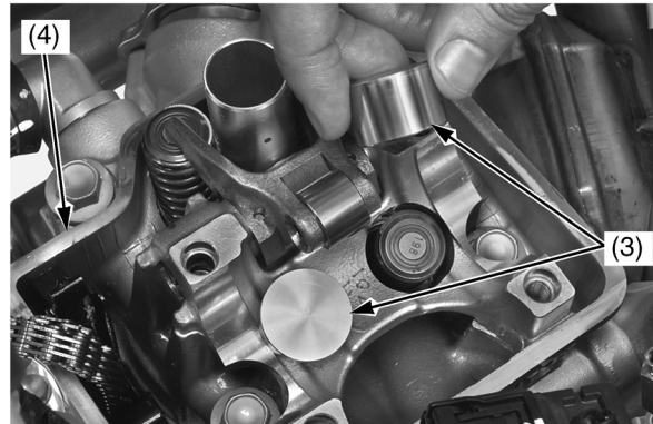
(3) толкатели клапанов (4) головка цилиндра
