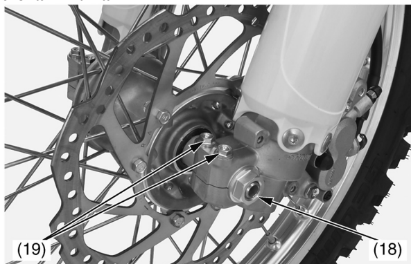
(18) гайка передней оси (19) левые стяжные болты оси
