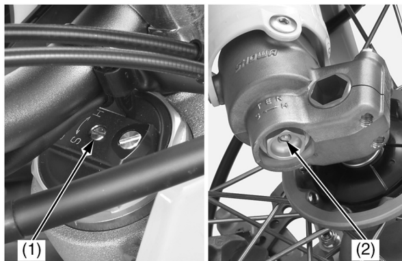
(1) регулятор усилия сжатия (2) регулятор усилия отбоя
