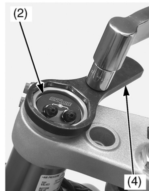
(2) пневмоцилиндр (3) демпфирующий узел (4) ключ для контргаек
