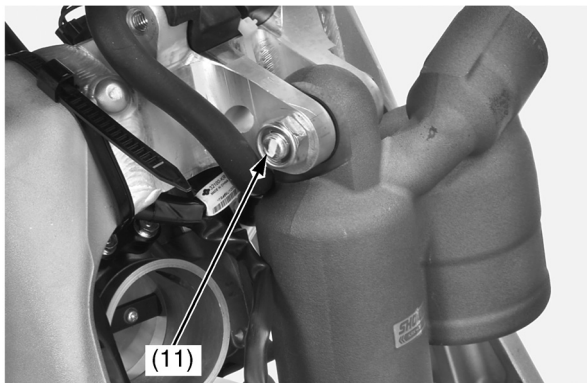
(11) верхняя гайка и болт заднего амортизатора
