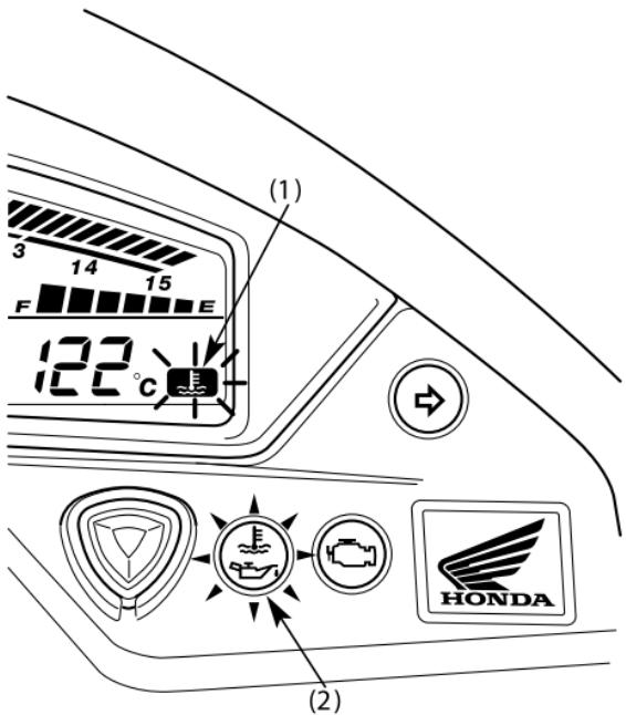
(1) Сигнализатор высокой температуры охлаждающей жидкости
