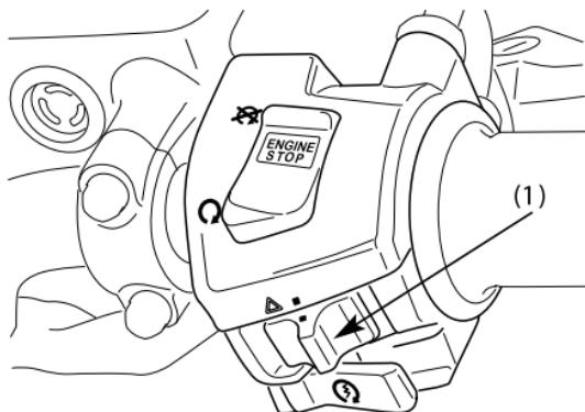
(1) Выключатель аварийной сигнализации
