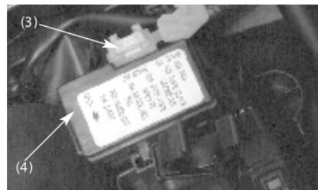
(3) Предохранитель системы впрыска топлива (FI) (CB600F)
