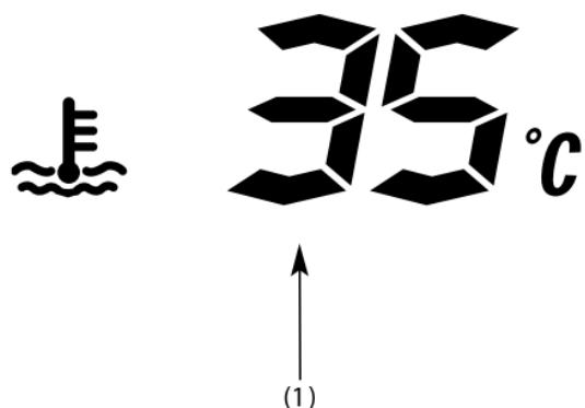
(1) Указатель температуры охлаждающей жидкости
