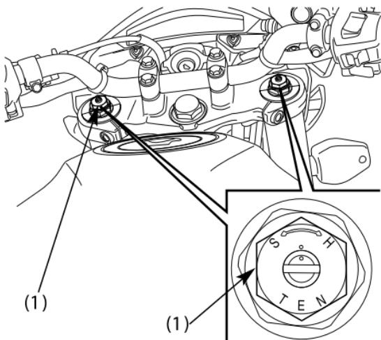
(1) Регулятор предварительного сжатия пружины
