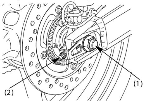
(1) Гайка задней оси
