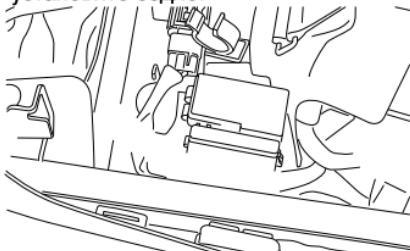
(1) Предохранитель системы впрыска топлива (FI) (CB600FA)
