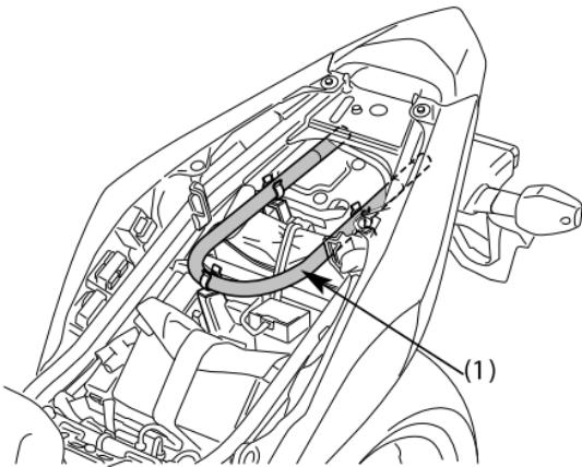
(1) Отсек для размещения механического противоугонного устройства
