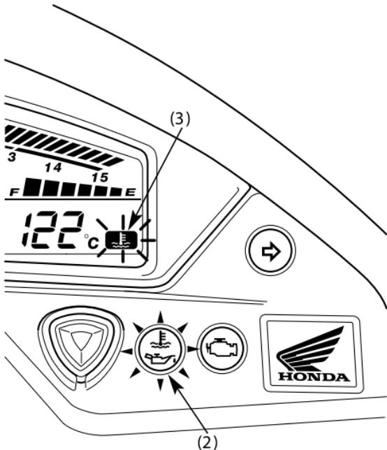
(2) Сигнализатор неисправности (MIL)
