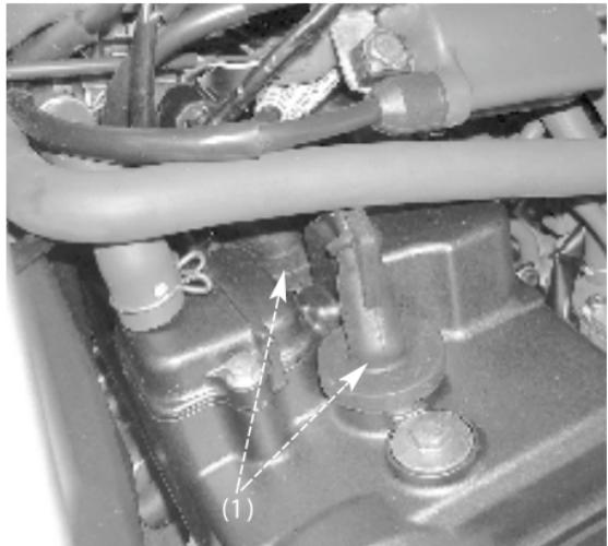
(1) Свечи зажигания
