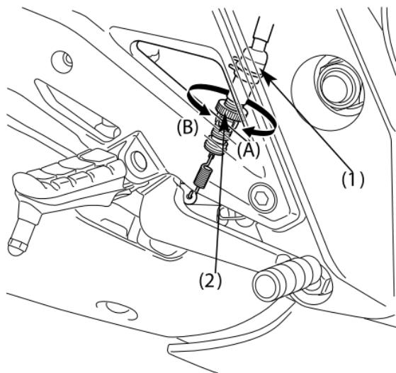
(1) Концевой выключатель стоп-сигнала
