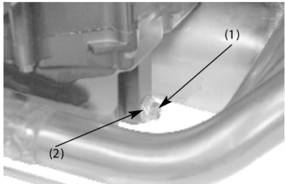
(1) Болт сливного отверстия картера
