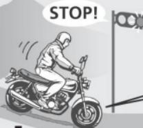
Закройте дроссельную заслонку и одновременно нажмите передний и задний тормоз.
