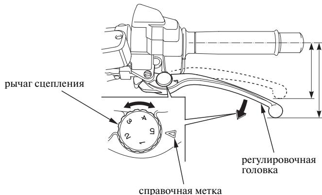
1. Поворачивайте регулировочную головку, одновременно отжимая рычаг сцепления вперед.
