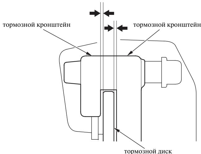
10. После установки переднего колеса нажмите на рычаг тормоза И педаль тормоза несколько раз, а затем перепроверьте зазор между обоими дисками и держателями тормозных суппортов. Не эксплуатируйте мотоцикл с неправильно выставленным зазором.
