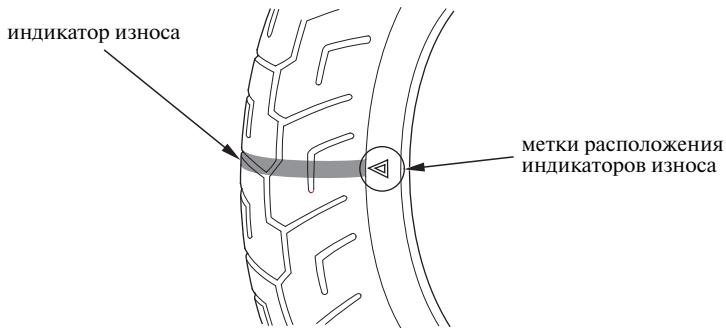
Если мотоцикл попал в выбоину на дороге или произошел наезд на твердый предмет, при первой же возможности остановитесь на обочине и осмотрите шины, чтобы убедиться в отсутствии повреждений.
