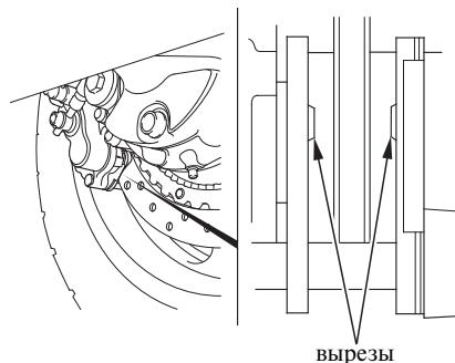
Проверьте вырезы в каждой тормозной колодке. Если степень износа какой-либо из колодок равна глубине выреза, замените обе тормозные колодки комплектом. Для выполнения этой операции обращайтесь к официальному дилеру.
