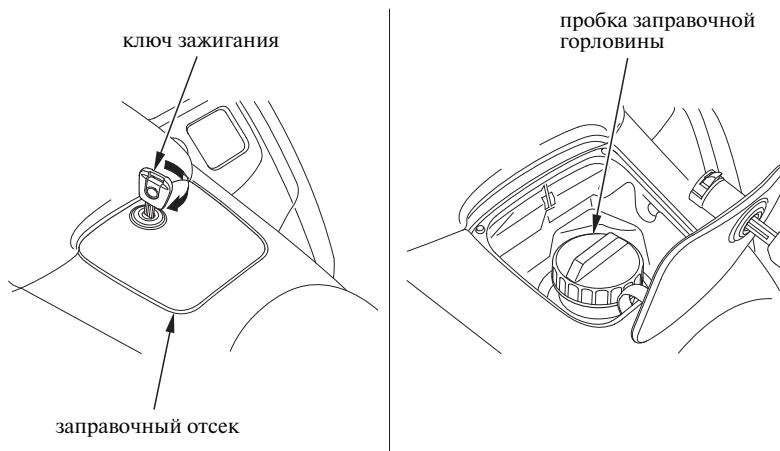
1. Вставьте ключ зажигания в заправочный отсек и поверните его по часовой стрелке.
