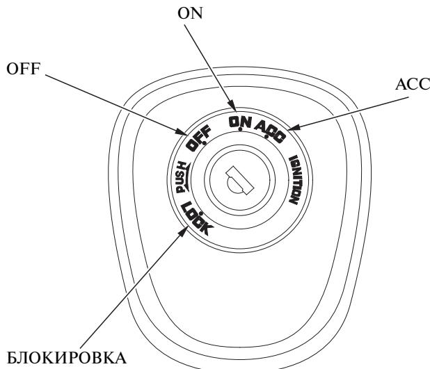
Замок зажигания служит для запуска и остановки двигателя (стр. 53) и блокировки руля для защиты от угона (стр. 63). Вставьте ключ и поверните его по часовой стрелке в положение ON (ВКЛ) и ACC (аксессуары).
