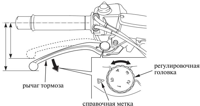
1. Поворачивайте регулировочную головку, одновременно отжимая рычаг тормоза вперед.
