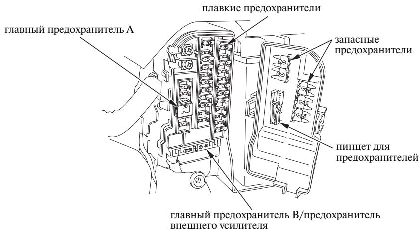
7. Закройте крышку блока предохранителей.
