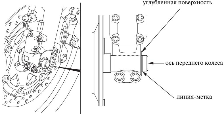
3. Затяните стяжные болты на левом пере передней вилки рекомендованным моментом:
