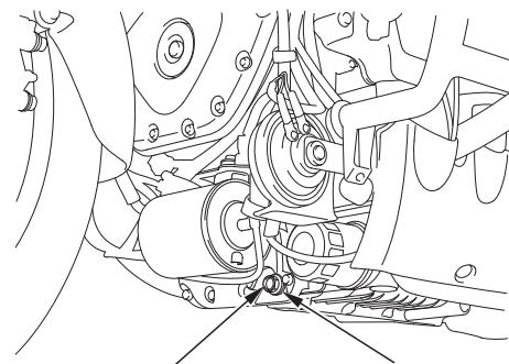
пробка сливного отверстия    уплотнительная шайба
