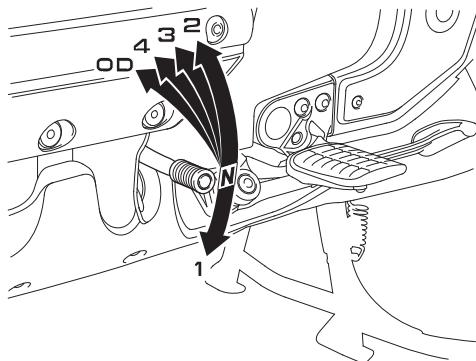
Данный мотоцикл оснащен пятью передачами (алгоритм переключения - включение первой передачи перемещением вниз и включение четырех передач перемещением вверх), переключение которых осуществляется системой сцепления с гидравлическим приводом.
