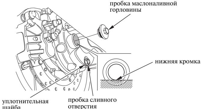
Замену следует производить, когда картер главной передачи нагрет до рабочей температуры. Это обеспечит полный и быстрый слив масла.
