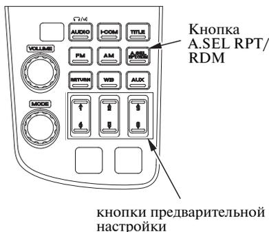
Если вы находитесь в удаленной зоне, функция автоматического выбора может не найти шесть станций с сильным сигналом в диапазоне AM волн и двенадцать станций с сильным сигналом в диапазоне FM. Если такое случится, на дисплее отобразится «0» при нажатии кнопки предварительной настройки, на которой не сохранена станция.
