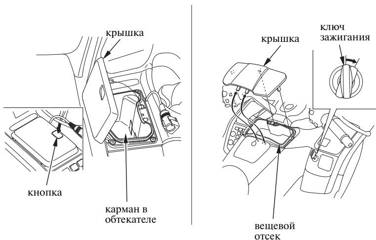
Карман в обтекателе и вещевой отсек предназначены для размещения легких предметов.
