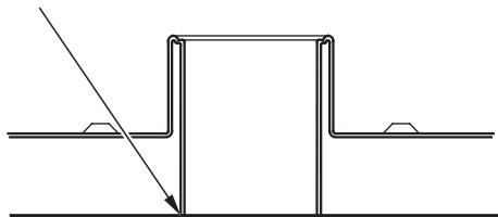
4. Долейте топливо до нижней кромки заливной горловины.
