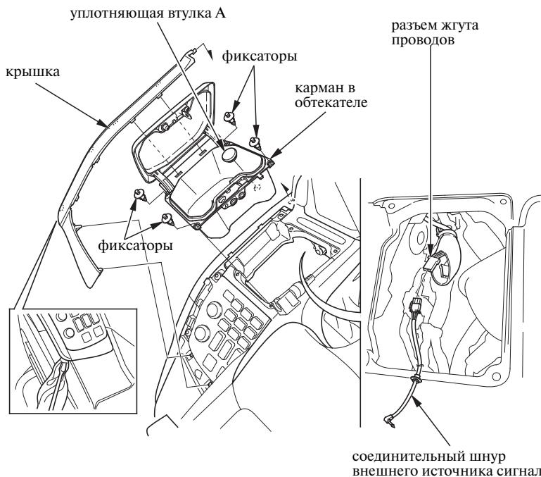
4. Выньте соединительный шнур внешнего источника сигнала из пакета с руководством по эксплуатации.
