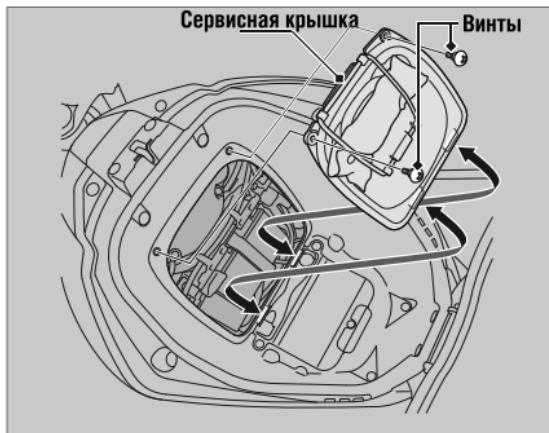
Снятие сервисной крышки требуется при снятии аккумуляторной батареи, а также для доступа к главному предохранителю и блоку предохранителей.
