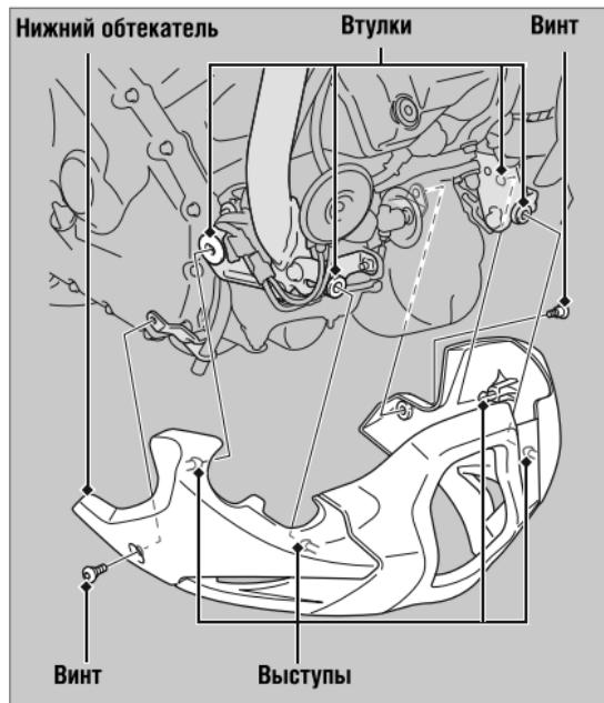
Для получения доступа к расширительному бачку системы охлаждения и замены масляного фильтра необходимо снять нижний обтекатель.
