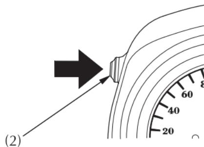
(2) Одометр / указатель пробега за поездку
