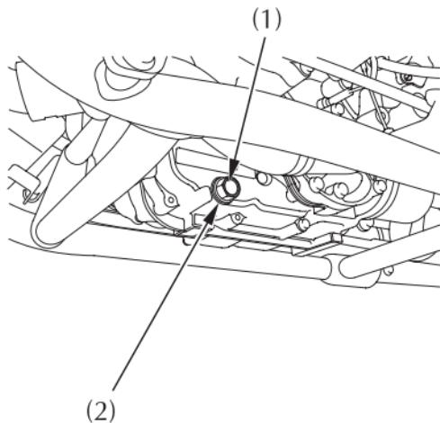
(1) Болт сливного отверстия
