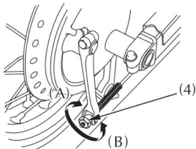
(4) Регулировочная гайка
