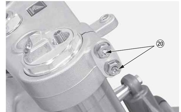
(20) верхние стяжные болты перемычки вилки
