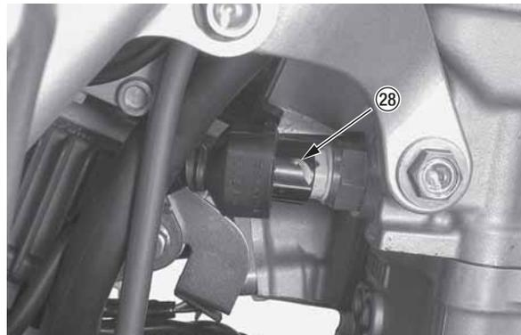
(28) разъем датчика температуры двигателя
