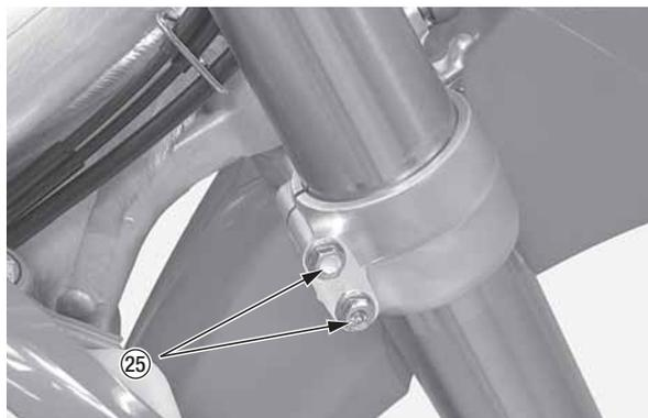
(25) нижние стяжные болты перемычки вилки
