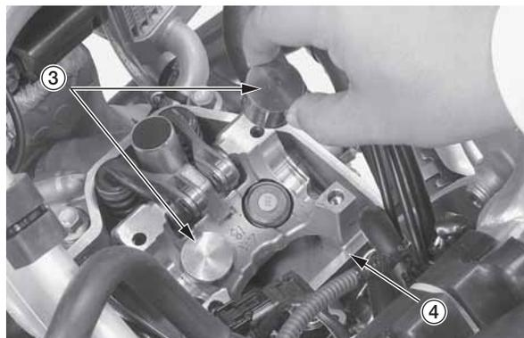
(3) толкатели клапанов (4) головка цилиндра
