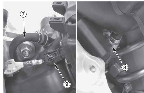
(7) патрубков вентиляционной трубки картера «А»
