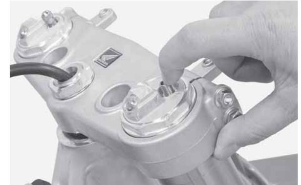
12. Ослабьте верхние стяжные болты перемычки вилки (20).
