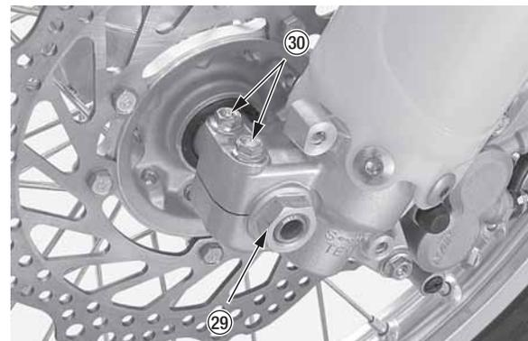
(29) гайка передней оси
