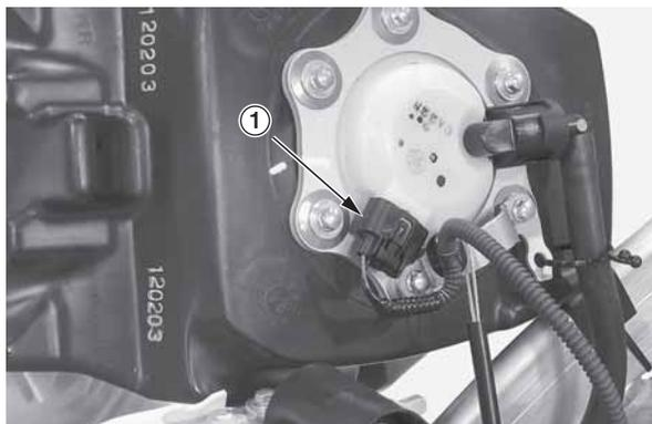
(1) разъем топливного насоса
