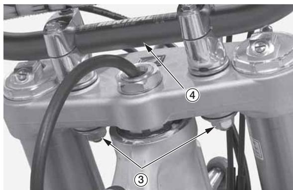
(3) нижние крепежные гайки руля, шайбы и установочные прокладки
