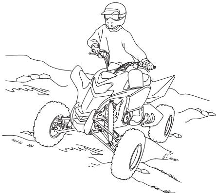
При поперечном движении по склону смещайте вес тела в сторону вершины склона.
