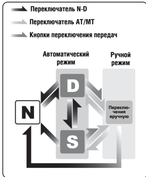
**Нейтральная передача (N):** Нейтральная передача включается автоматически при повороте замка зажигания в положение “ON” (ВКЛ.)
