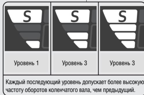
Выбранный уровень сохраняется в памяти даже после выключения зажигания (положение **O** (Off) (Выкл)) и выключения режима S.
