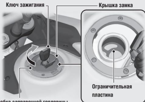
Пробка заправочной горловины топливного бака
