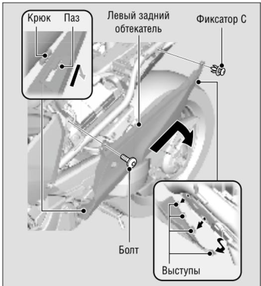
Снятие левого заднего обтекателя необходимо при снятии аккумуляторной батареи.
