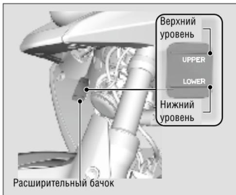
Если уровень охлаждающей жидкости очень мал или расширительный бачок пуст, значит в системе присутствует серьезная утечка. Обратитесь к дилеру для проверки мотоцикла.
