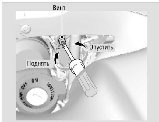
Другие регулировки ► Регулировка концевого выключателя стоп-сигнала
