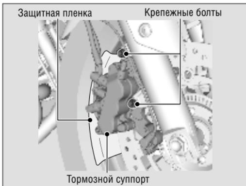
3. С левой стороны выверните крепежные болты и снимите тормозной суппорт.
