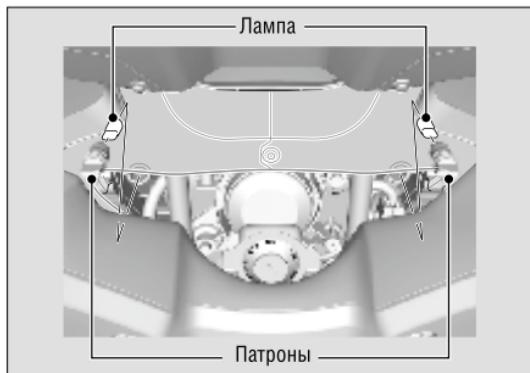
1. Вытяните и извлеките патрон лампы стояночного света.
