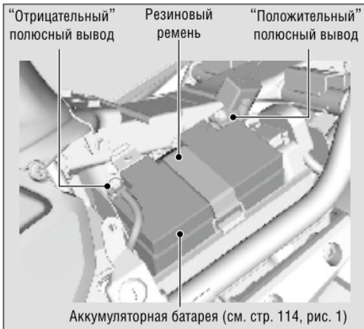
3. Отсоедините клемму от “отрицательного” вывода  $\ominus$  аккумуляторной батареи.
