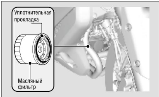
7. Нанесите тонкий слой моторного масла на резиновое уплотнительное кольцо нового масляного фильтра.
